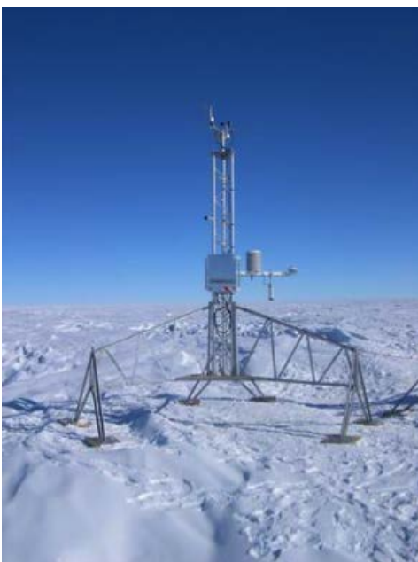
Figura 3. AWS Irene (Sitry). Da notare la struttura dalla caratteristica forma piramidale e il treppiede alla base per ottenere un miglior rapporto stabilità-peso.
